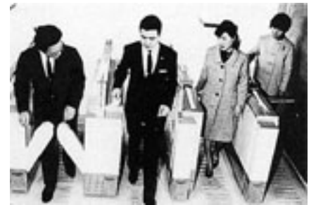
自動改札機等の開発により、世界初の無人駅システムを実現
